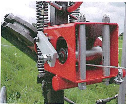
Umbau einer Bestandwinde: Eine „Messrolle“ auf dem Schleppseil steuert die pneumatisch betriebene zusätzliche Bremszange und verändert sicher den gefürchteten „Seilsalat“.
