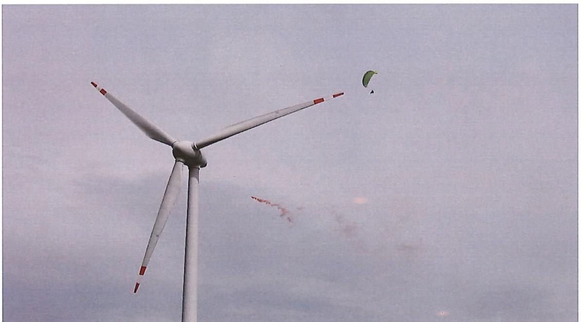
Bild 4: Turbulente Strömung im Lee einer WKA. Bei Windgeschwindigkeiten zwischen 20 km/h und 30 km/h waren deutliche Turbulenzen, auch in einem Abstand von über 300 m, feststellbar. Das Bild zeigt die Wirbelstruktur und einem größer werdenden Drall (Rauchpatrone). Foto: DHV
