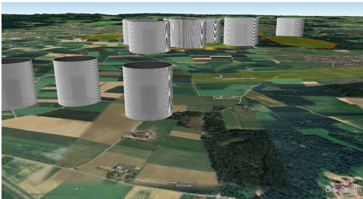
Abbildung 4: WKA mit eingezeichneten vorgeschriebenen Sicherheitsabständen
