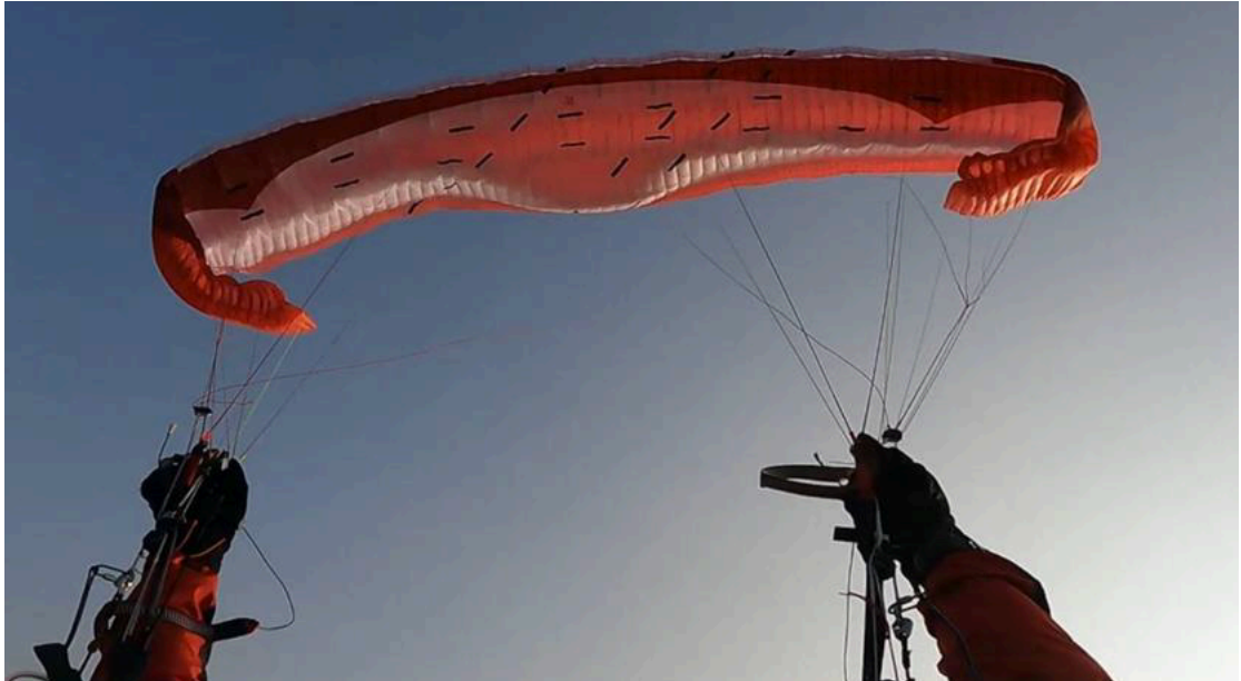
Abbildung: Boomerang 13 in einem stabilen Sackflug nach einem frontalen Einklapper. Die Hinterkante des Gleitschirms geht nach oben, was verhindert, dass der Schirm in den normalen Flug zurückkehrt.
