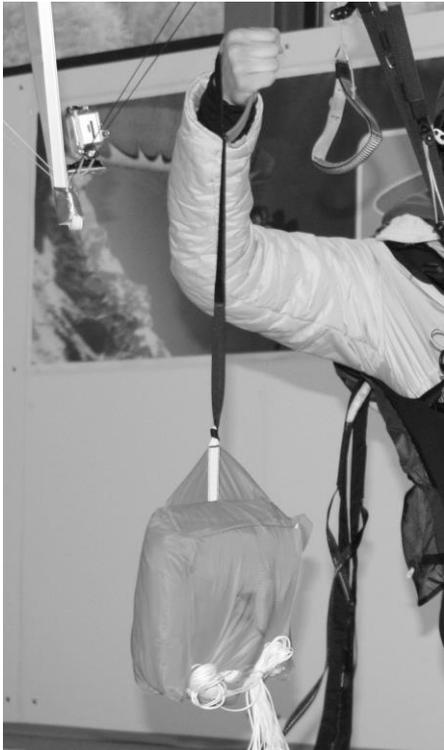
*Bild 6 zeigt, dass eine lange Verbindungsleine Griff-Innencontainer das Wegschleudern erschwert,*
