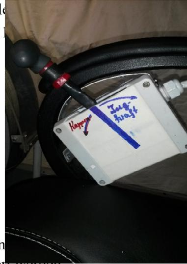
Wird der Fahrhebel über einen deutlichen Druckpunkt hinweg entgegen der Zugrichtung gedrückt, werden beide Kappvorrichtungen gleichzeitig elektrisch ausgelöst.
