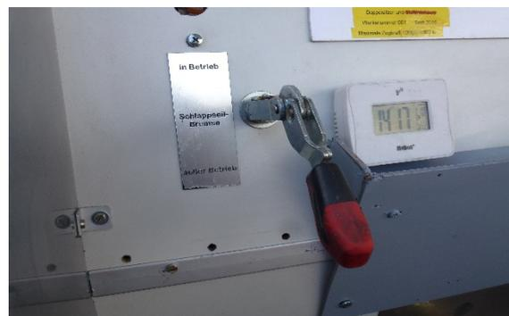
Der Trommelnachlauf beim Seilausziehen wird mit der Seilbremse gebremst. Die Seilbremse der rechten oder linken Trommel kann mit den Hebeln (9 u. 10) einzeln außer Betrieb genommen werden.
