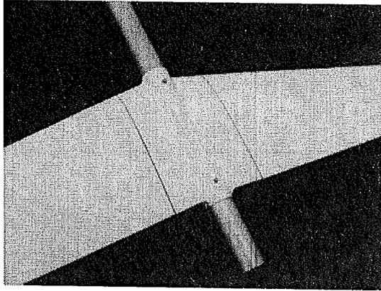
6. Stellen sie zwei Stützen ca. 1,7m lang unter jeden Flügel bei der Unterverspannungsbefestigung, so dass die Unterverspannungen gespannt sind.
