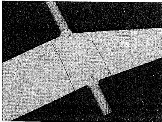
**WARNUNG! DAS LEITWERK MUSS SO MONTIERT SEIN, DASS DIE FLÜGELSPITZEN NACH OBEN UND NACH HINTEN ORIENTIERT SIND! EINE FALSCHER MONTAGE KANN GEFÄHLICHE FLUGEIGENSCHAFTEN ALS FOLGE HABEN!**
