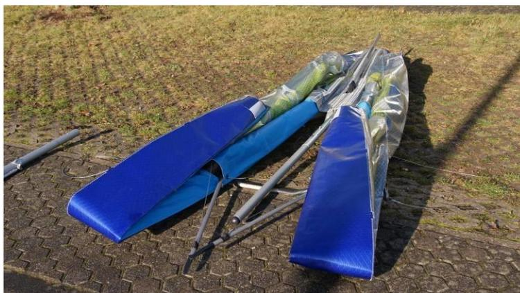
Legen Sie den kurzgepackten Fizz mit dem Trapezbereich nach oben zeigend auf den Boden. Öffnen Sie den Reißverschluss und legen Sie den Lattenköcher und die beiden hinteren Flügelrohre zur Seite. Falls Sie mit luftbereiften Rädern fliegen, schieben Sie vor der Montage der Trapezbasis die Räder auf die Speedbar.
