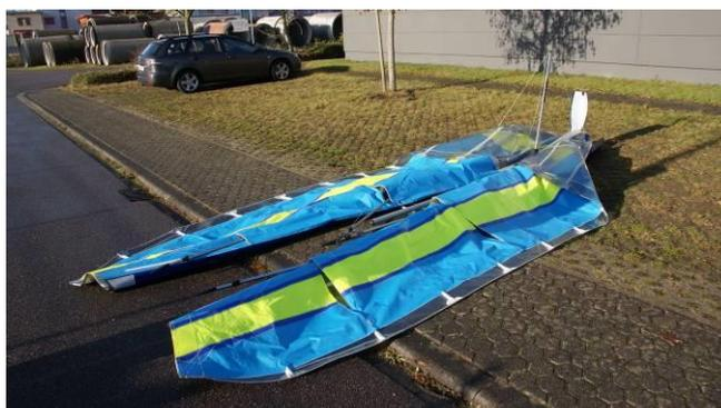
Schieben Sie die äußeren Flügelrohre dann von hinten in das Segel. Führen Sie den Swiveltip an der Reißverschlussöffnung des Doppelsegels wieder nach außen und schieben Sie das Rohr mit nach oben zeigendem Swiveltipseil in das vordere Flügelrohr. Der Swiveltip schwenkt dabei nach hinten. Drücken Sie die beiden Schnapper ein und achten Sie darauf, dass die beiden eingedrückten Schnapper im vorderen Flügelrohr ausrasten.
