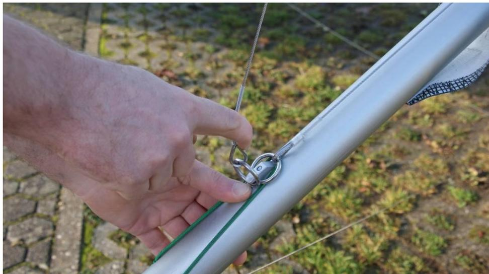
Danach wird der Stahlring des hinteren Oberriggs ebenfalls dort eingehängt. Prüfen Sie, ob der Schnapper hinter den beiden Ringen ausgerastet ist.
