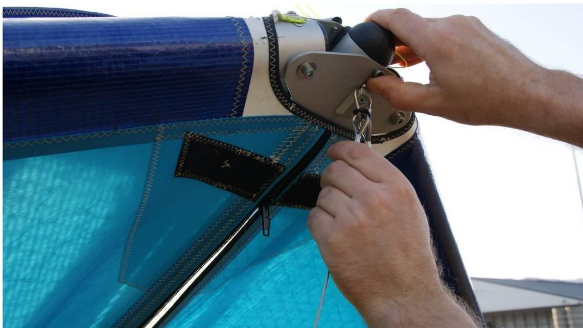
Danach wird der Schnappkarabiner des Querrohrsicherungsseils von **unten nach oben** in die Spannseil-Lasche am Querrohr eingehängt und anschließend der Reißverschluss des Doppelsegels zugezogen.
