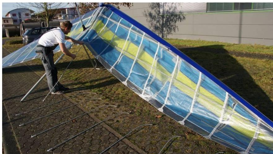
Rote Lattenzahlen = linke Seite, grüne = rechte Seite (in Flugrichtung gesehen). Im Lattenköcher sind für die linke und rechte Segelhälfte getrennte Lattenfächer angeordnet. Nachdem Sie die Obersegellatten eingeschoben haben, können Sie das Gerät aufrichten und spannen.
