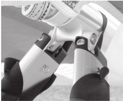
Checken Sie die Unterverspannung an den Trapezecken und stellen Sie sicher, dass es dort keine Knicke oder verdrehten Kauschen gibt. Prüfen Sie auch den korrekten Sitz aller Muttern und Sicherungsringe an den Trapezecken. Stellen Sie sicher, dass alle Quickpins vollständig durchgeschoben und gesichert sind.
