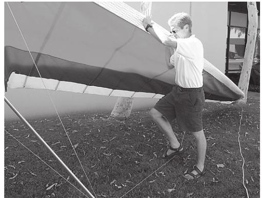
Drücken Sie nun das Flügelrohr zwischen Drachennase und Querrohranschluss nach oben und drücken Sie mit dem Fuß die seitliche
