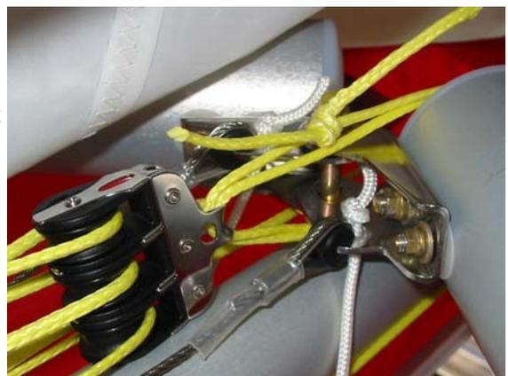
Nehmen Sie auch eine Sichtprüfung der Querrohre vor, indem Sie entlang beider Hälften nach Anzeichen für Beschädigungen schauen.
