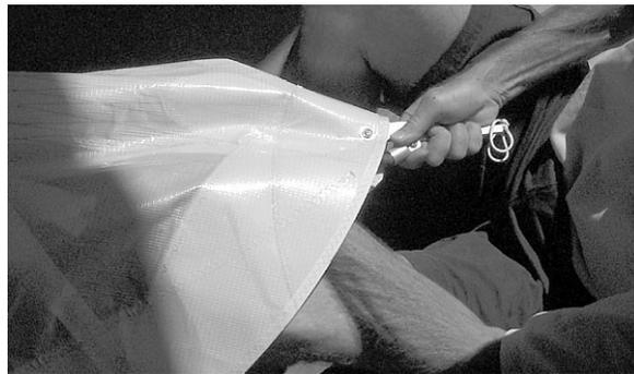
7. Schwenken Sie die Flügelhälften vollständig nach innen zum Kiel und ziehen Sie dabei das Segel nach oben heraus über die Anströmkante. Nehmen Sie jetzt die vorderen Enden der Mittellatten von den Zapfen am Kiel und ziehen Sie sie ein paar Zentimeter heraus.
