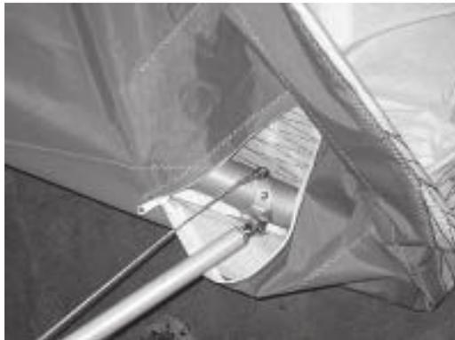
3. Reindreihen des Gabelkopfes verkürzt die Länge des Swivels, Rausdrehen verlängert die Länge des Swivels. Da das Swivelseil gleich lang bleibt ergibt Reinschrauben ein Absenken der Swivelhöhe (weniger Verwindung), Rausschrauben ein Anheben der Swivelhöhe (mehr Verwindung). Eine Umdrehung verändert die Höhe des äußeren Swivels um ca. 13 mm, die des inneren Swivels um ca. 6 mm.
