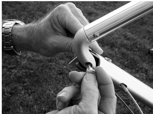
Stellen Sie sicher, dass die kleinen Buchsen, welche die Lasche der Unterverspannung im Seitenrohr halten, korrekt sitzen.
