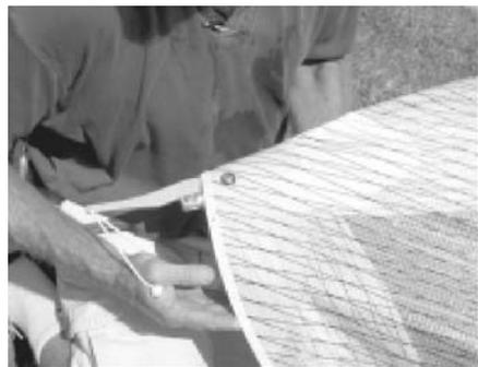
11. Bevor Sie den Klettverschluss der Segelöffnung schließen, schauen Sie ins Segel und prüfen Sie, ob der Reißverschluss an der äußersten Stoffrippe vollständig geschlossen ist und dass der "BACK"-Aufkleber auf dem Randbogenstab richtig ausgerichtet ist – er sollte jetzt auf den Teil des Spannhebels ausgerichtet sein, der am Randbogenstab anliegt. Schließen Sie dann die Segelöffnung.
