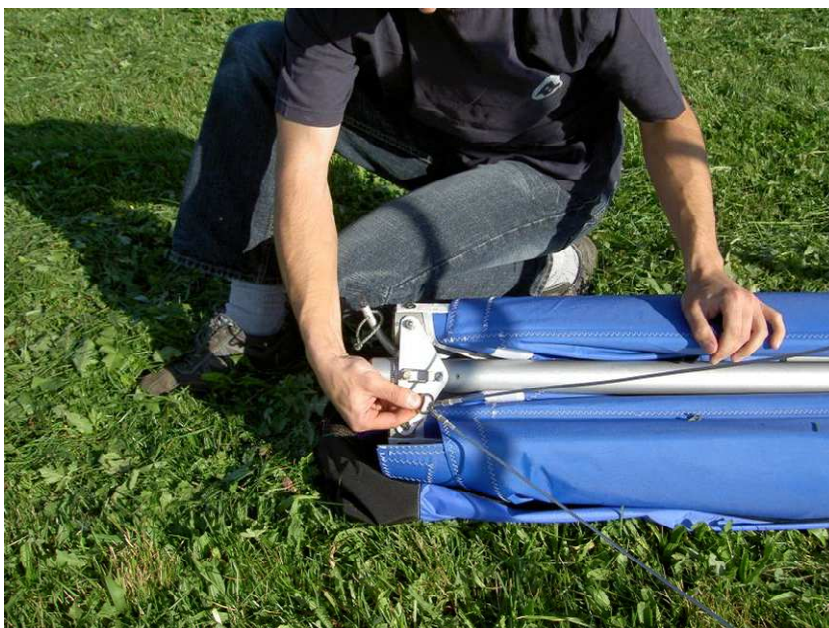
Vorderverspannung an der Nase einhängen
