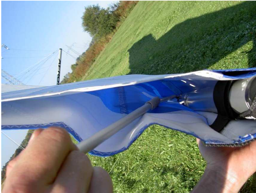
Spannlatte am Flügelende einfügen
