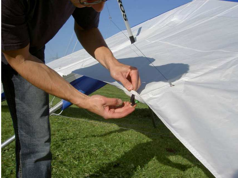
Segellatten in das ungespannte Segel einschieben und sichern.
