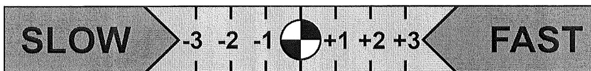
Vor dem ersten Flug ist die Pilotenaufhängung nach unten stehender Tabelle zu positionieren. Dazu den Klett der Pilotenaufhängung lösen, diese verschieben und anschließend den Klett an der neuen Stelle wieder befestigen. **Dabei darauf achten, dass das Ende, an dem der Karabiner befestigt wird, durch beide Schlaufen gesteckt wird.** Der gewünschte Skalenwert muss in Aufhängungsmitte liegen.
