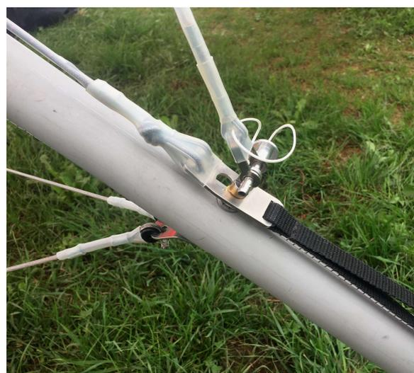
Danach wird der Sicherungsverschluss des Oberriggs ebenfalls dort eingehängt und mittels Quickpin gesichert.
