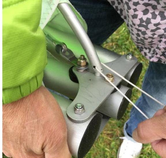
**Segelfläche ausbreiten:** Schiebe nun die Segellatten von innen nach aussen (d.h. von Latte 1 beginnend) in die Segellattentaschen und sichere diese mit den Lattenclips und den Lattenschnüren. Nachdem Du die Obersegellatten eingeschoben hast, kannst Du das Gerät mittels Kabel spannen und am Kielendverschluss einrasten.
