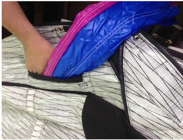
c. Vergewissere dich, dass sich der Griff außen befindet. Schließe den Reißverschluss:
