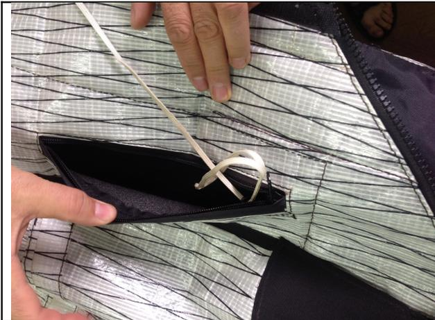
a. Befestige die Bremsleine an der Schlaufe in der Tasche. Falte die Kappe des Bremsschirms und wickle die Fangleinen in die Kappe ein, um weniger Reibung beim Auslösen zu erzeugen.
