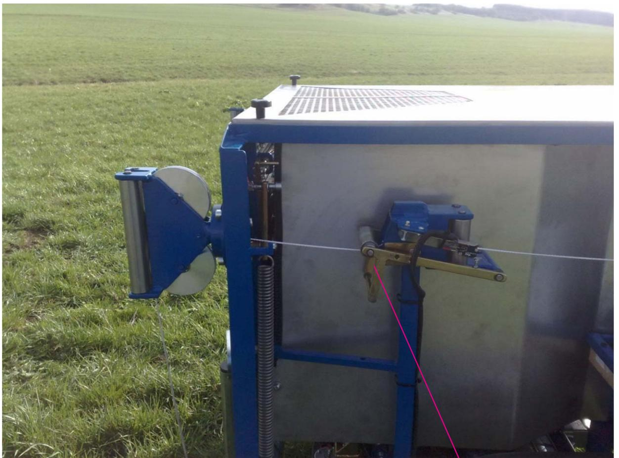
Das Schleppeil muss unbedingt unter der Bremsrolle eingefädelt werden.
