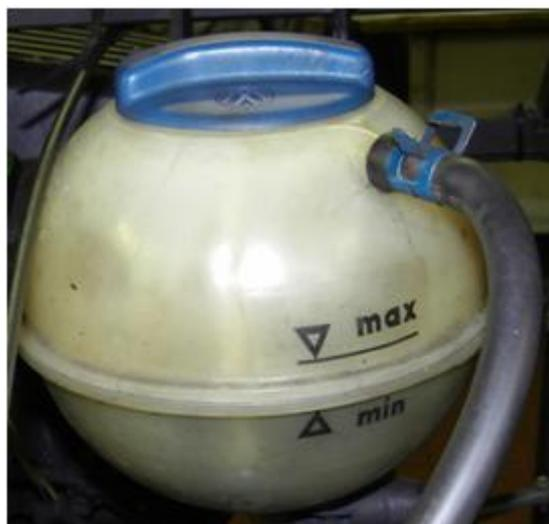
5. Bremsflüssigkeitsstand prüfen. Ein geringfügiges Absinken des Flüssigkeitsstandes entsteht im Betrieb durch die Abnutzung und automatische Nachstellung der Bremsbeläge. Das ist normal.
