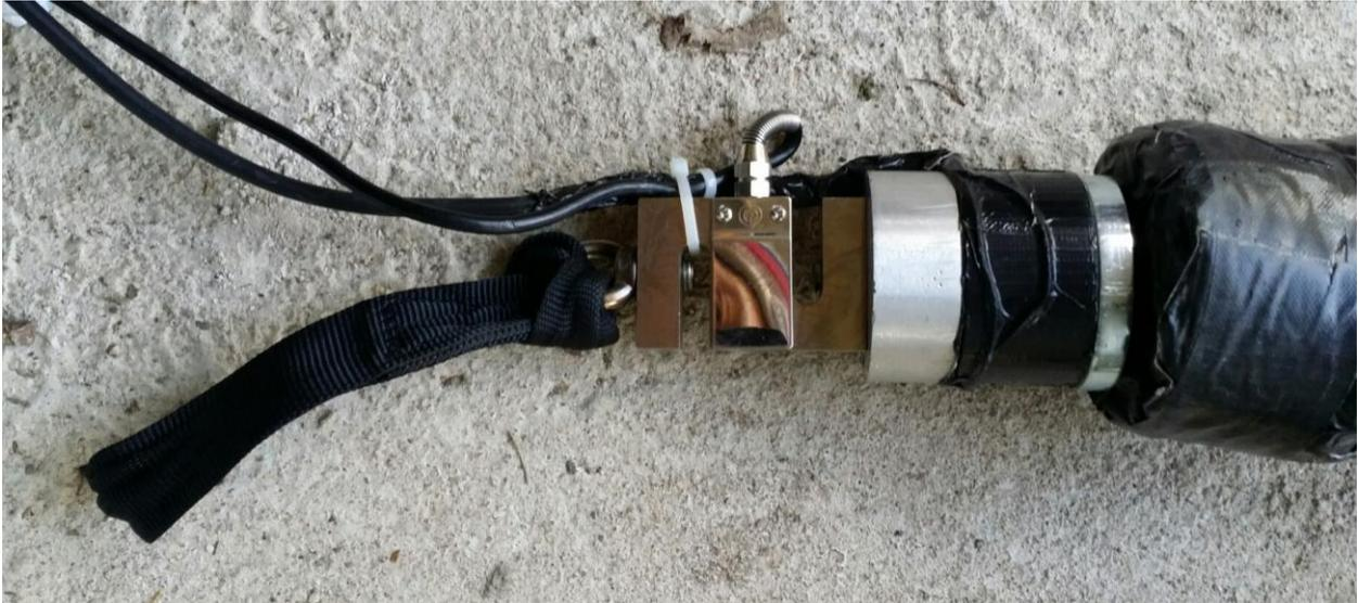
**Bild 4 Trennvorrichtung entkoppelt und teilweise ohne Polsterung**
