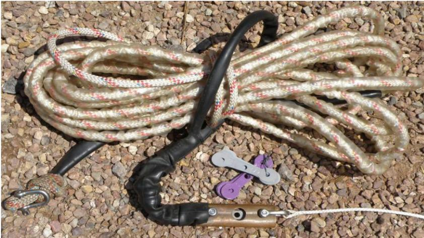
**Bild 21 Sollbruchstelle mit / ohne Gehäuse**
