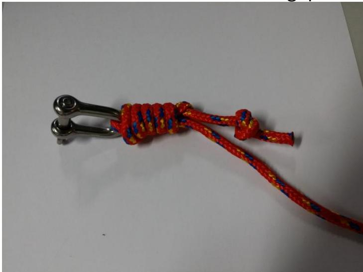
Das lose Schnurende bis auf etwa 5 mm kappen und mit Feuerzeug oder Heißluft verschmelzen.
