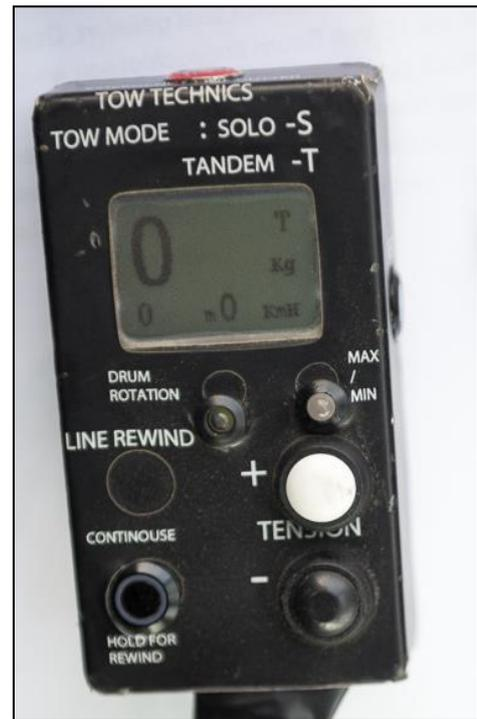
Abb. 18 Windensteuerung
