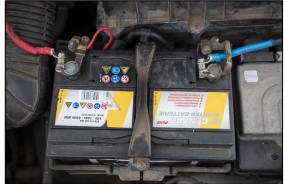
Abb. 8 Anschlusskabel der T2 korrekt mit der Autobatterie verbunden
