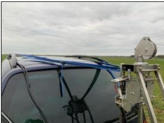
Abb. 5 Absicherung des Turms durch Spannbänder
