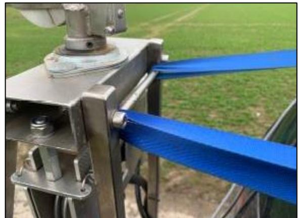
Abb. 6 Befestigung der Spannbänder an der Verstrebung der Winde
