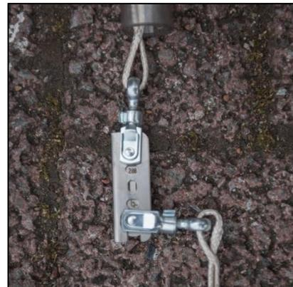
Abb. 17 Sollbruchstelle im Blechkäfig mit der offenen Seite in Richtung Pilot
