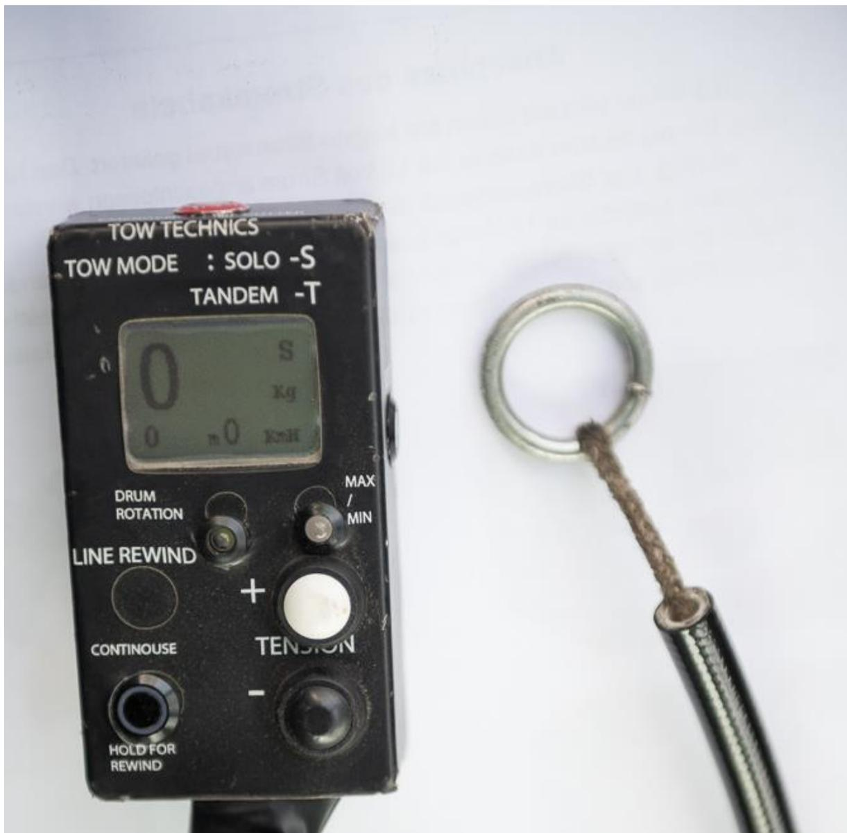
**Abb. 21** Windensteuerung und Zug für die mechanische Kappung
