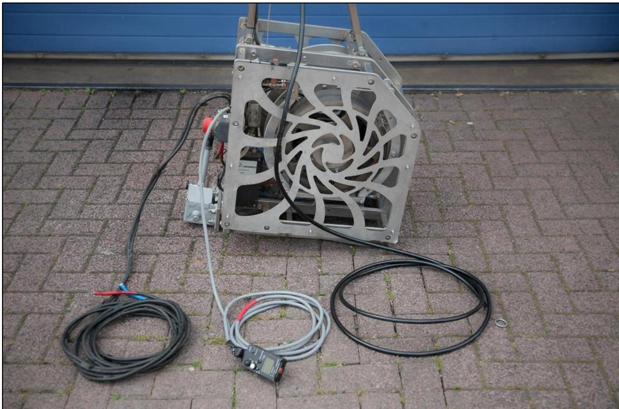
Abb. 23 Abbildung der TowTechnics T2 mit Kabeln und mechanischem Zug der Kanppvorrichtung
