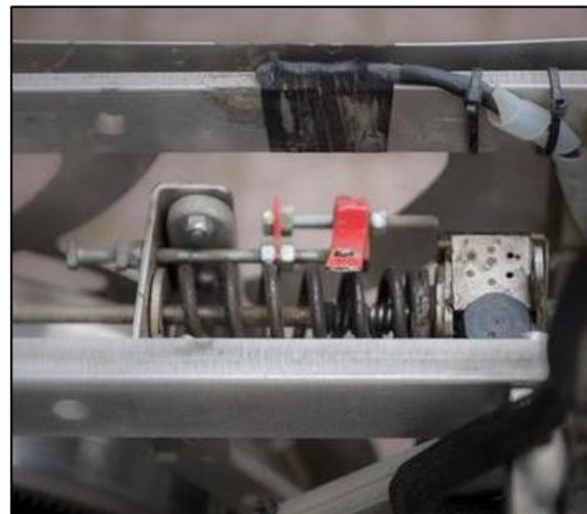
Abb. 20 Schalterstellung für Soloschlepp
