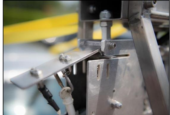
Abb. 12 entspannter Zustand der Kappvorrichtung im Detail
