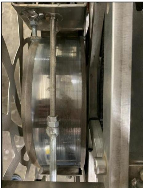
Abb. 27 Einstellung der Vorspannung mit Hilfe einer Gewindestange und Kontermuttern
