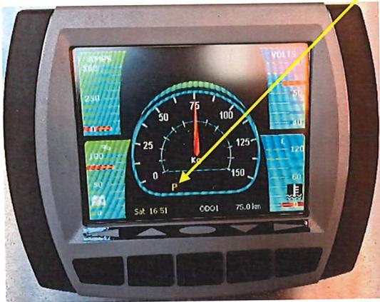
Beim Einschalten des Hauptschalters und des Schlüsselschalters befindet sich das Display im Zugkraftvorwahlmodus.
