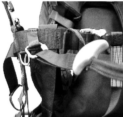
**C)** Einschlaufen der beiden Klinkenhälften in die Karabiner der Hauptaufhängung. Dabei müssen die Öffnungen der Karabiner nach außen/hinten zeigen, während die Klinke jeweils auf die Innenseite der Karabiner eingeschlaucht wird. Gegebenenfalls ist die Klinke gegen verrutschen zu sichern. Der Griff muß nach außen/oben zeigen!:
