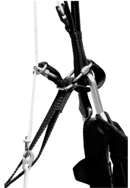
Bei der Variante 2 und 3 kann auch nach der Trennung der volle Beschleunigungsweg ausgenutzt werden.
