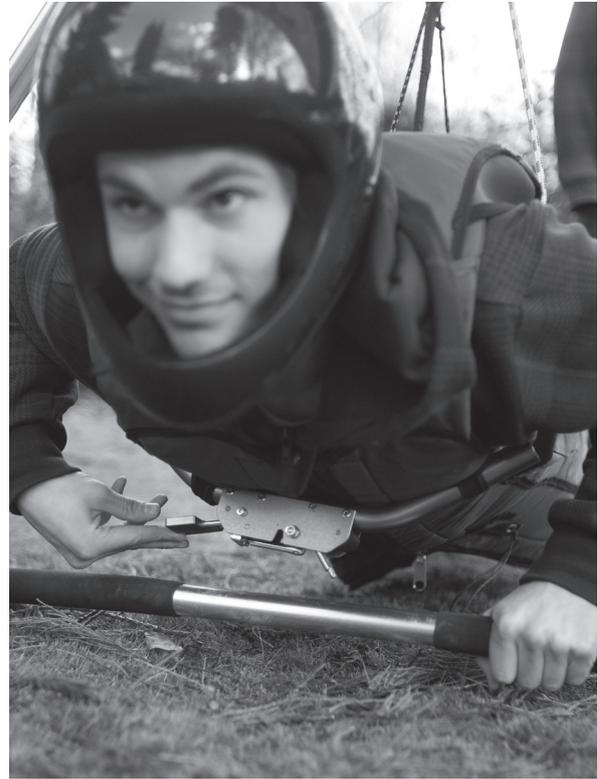
Druck auf den längeren Hebel öffnet beide
