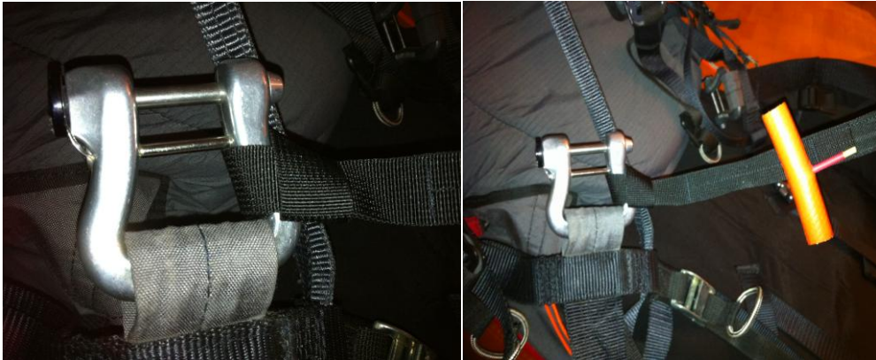
Abbildung 1+2: Befestigung durch Einschlaufen in die Pinlock-Karabiner der Hauptaufhängung (nicht zwischen den Bolzen!)
