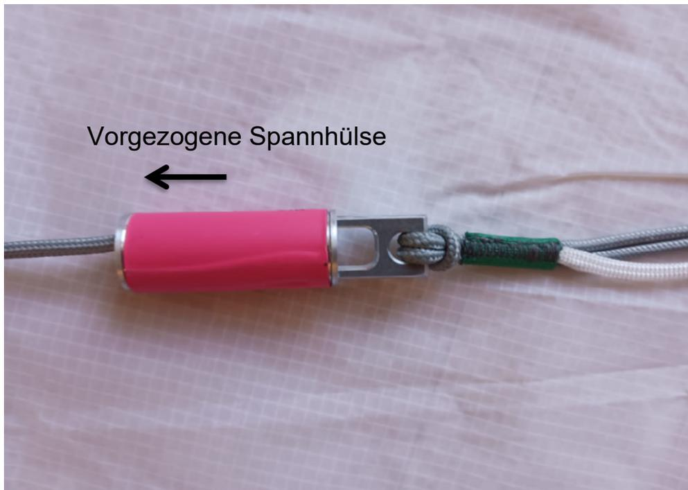
Abbildung 5.3: Schleppklinke im startbereiten Zustand
