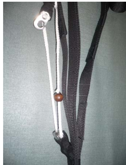
Kugel weiter unten=kürzerer Weg, mehr Kraft
