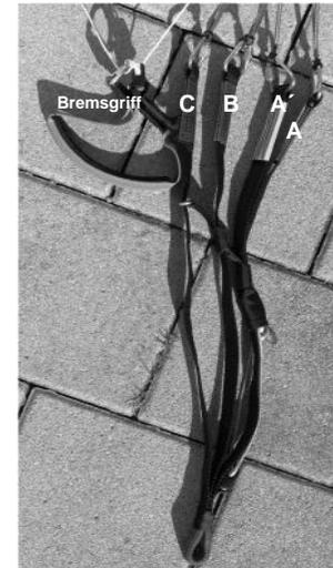
Der **CYBER TE** hat 3-fach-Tragegurte mit Beschleuniger. Der A- Tragegurt ist geteilt (A, A') wodurch das Ohrenanlegen erleichtert wird.
