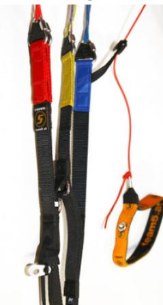
Durch die profilspezifischen Verkürzungen der A-, B- und C-Gurte wird der EXPLORER sehr effektiv um ca. 14 km/h beschleunigt ohne dabei deutlich an Stabilität einzubüßen. Um das Beschleunigungssystem zu montieren, ist eine Umlenkrolle unten am Gurtzeug erforderlich. Die Beinstrecker-Leine läuft wie gewohnt über eine oder mehrere Umlenkrollen am Gurtzeug nach vorne und muss in geeigneter Länge mit dem mitgelieferten Rohr verbunden werden.
