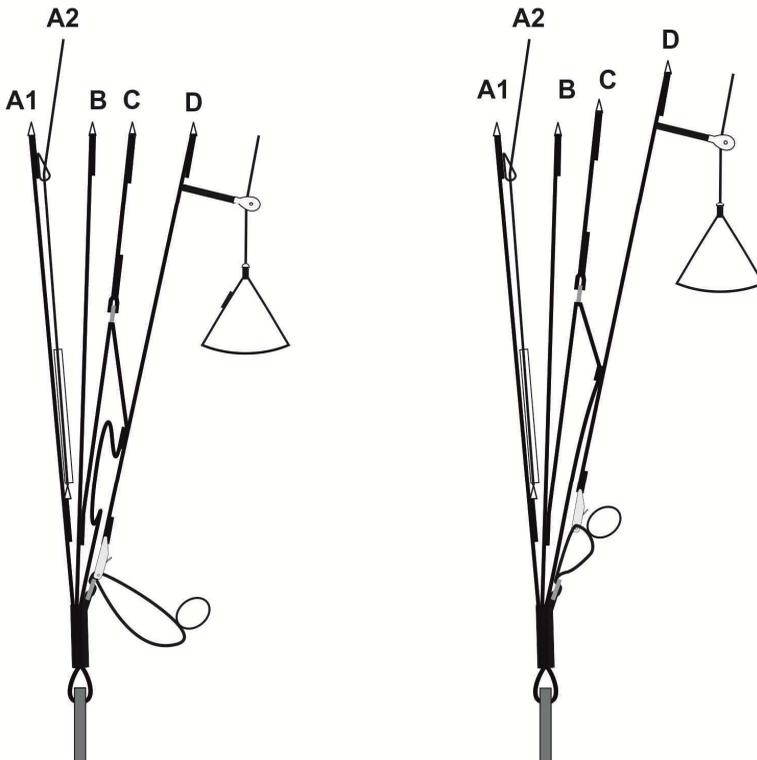
Abbildung 6: Skizze Tragegurte TWIN 5 mit Darstellung Funktionsweise Trimmer
