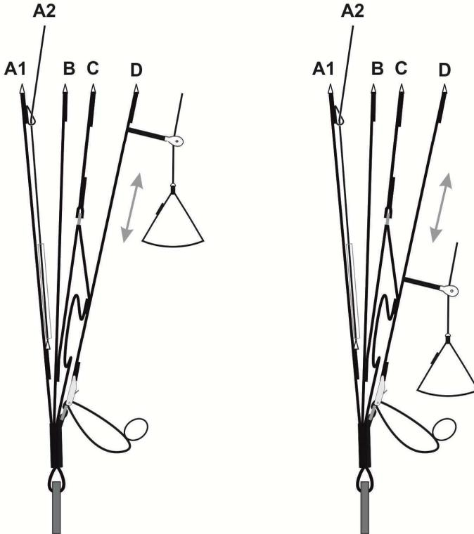
Abbildung 5: Skizze Tragegurte TWIN 5 mit Darstellung Funktionsweise Bremsslider
