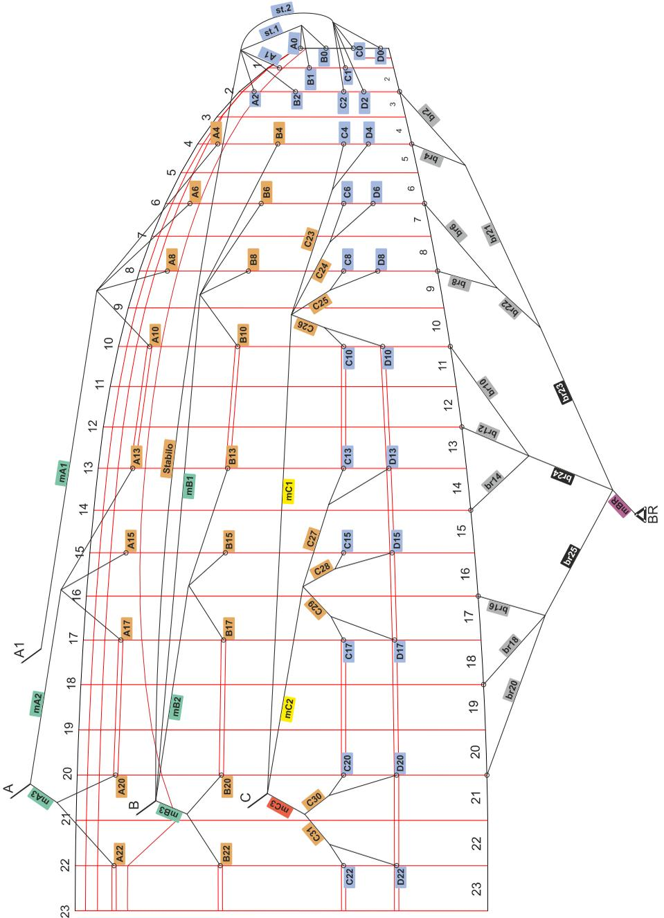
Die Leinen werden ausgelegt und mit 5 daN belastet. Die Vermessung erfolgt vom Einhängepunkt des Tragegurtes bis zur Kappe einschließlich Fangleinenloop.
