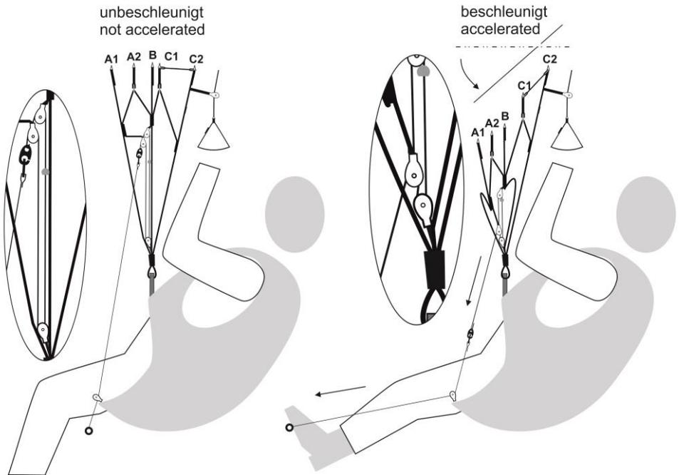
**Abbildung 5:** Funktionsweise Fußbeschleuniger Nexus
