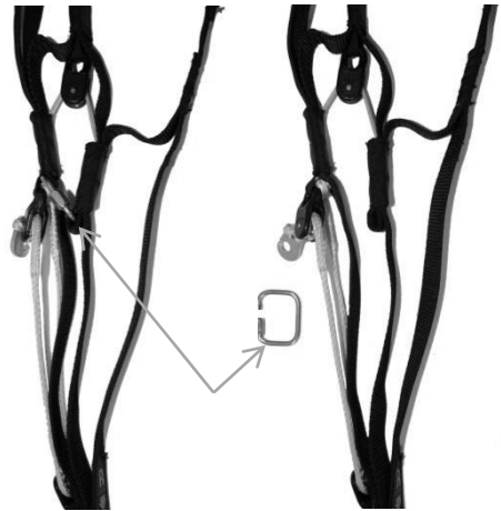
Abbildung 12 Mitotragegurt mit und ohne Speedlimiter
