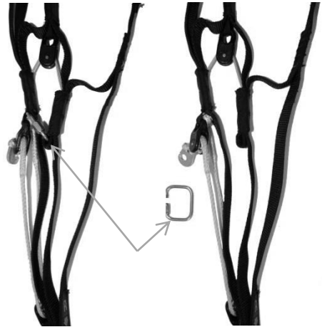
Abbildung 12 Mitotragegurt mit und ohne Speedlimiter
