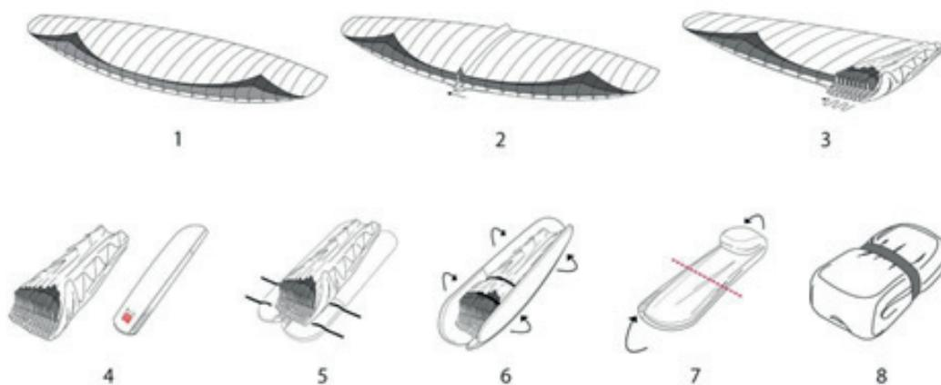
Abbildung: Richtiges Packen des Fuse 2
