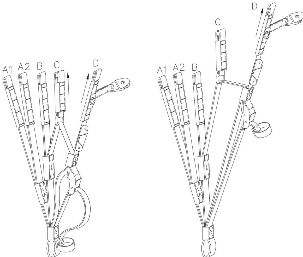
Abbildung: Tragegurte des Fuse 2
