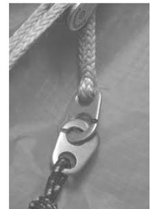
Bei Nichtbetätigung sind alle Tragegurte gleich lang. Wenn Du jedoch die Fußstange durchtrittst, werden die Tragegurte um eine konstruktiv genau festgelegte Länge verkürzt. Dadurch kommt es zu einer Verkleinerung des Anstellwinkels am gesamten Flügel und gleichzeitig zu einer Geschwindigkeitszunahme.
