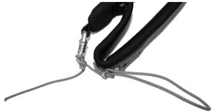
Fig. 10 Herausziehen der Leine aus der Schlaufe
