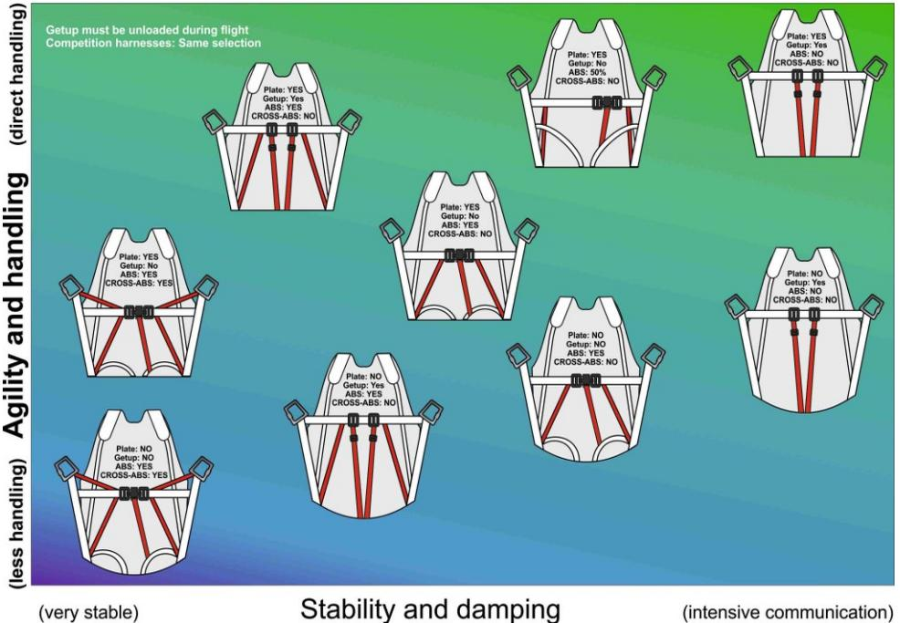
Fig. 14 **Übersicht verschiedene Gurtzeuggeometrien und deren Dämpfung**
