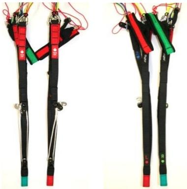
Fig. 3 MITO 2 RS Tragegurte mit Seitenmarkierung
