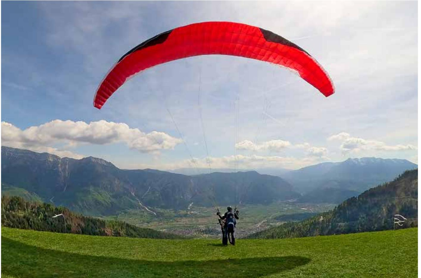
Bei viel Wind kann man die Trimmer bis zur Hälfte öffnen. Dabei ist allerdings zu beachten, dass sich dann die Kappe sehr schnell füllt und beim Anbremsen sofort Auftrieb erzeugt. Das kann zum frühzeitigen Aushebeln führen.
