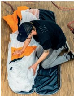
Mit dieser Technik liegt der Schirm wie eine Ziehharmonika von Flügelende bis Flügelende beieinander und wird in der Schirmmitte nicht gefaltet. Somit werden weder die mittleren Zellen noch die Rigid Foils vermehrt beansprucht. Die Öffnungen an der Eintrittskante müssen dabei zur Mitte des Guardbags ausgerichtet sein.
