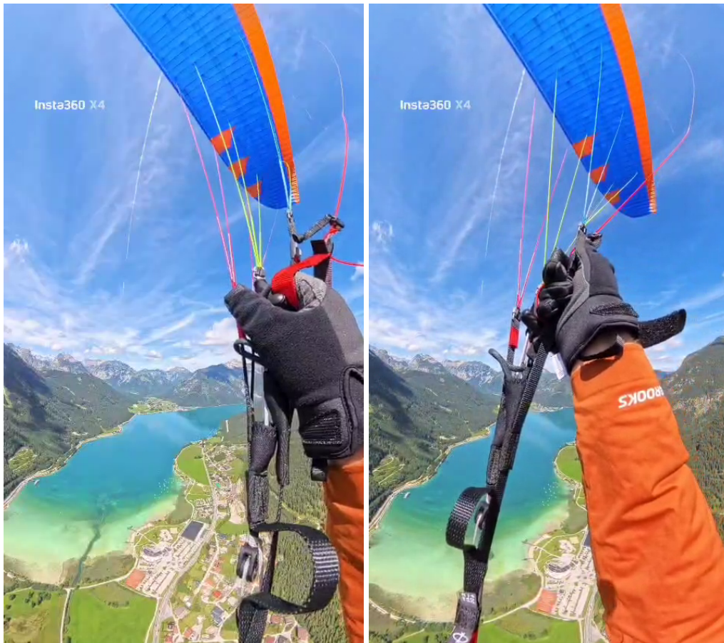
Bedienung des R14 Tragegurt mit Carbon Griff (Handle) oder direkt am Soft-Griff.
