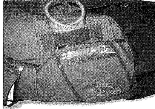
Packschlaufen entfernen und anschließend kontrollieren der Container korrekt verschlossen ist
