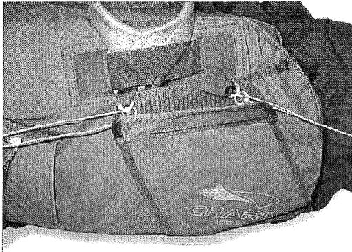
Mittlere Klappe wie abgebildet mit rechtem und linkem Splint verschliessen - durch den Loop stecken und den Auslösegriff in den Schlaufen befestigen
