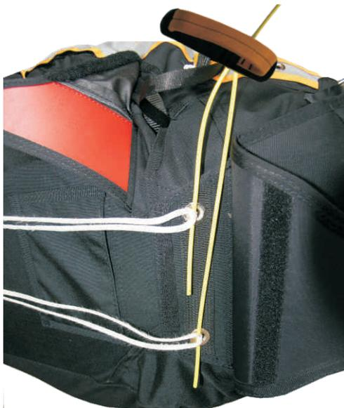
Jetzt den vorderen Containerlappen schließen und mit den beiden unteren gelben Verschlusskabeln sichern. Keinesfalls die lange Seite des Kabels durch beide Loops führen!!!
