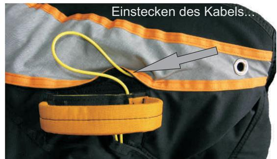
Dieses einzelne gelbe Kabel verläuft vom Rettungsgeräte-Griff zur Trennvorrichtung des Beinstreckers wie in der Abbildung ersichtlich innerhalb des Gurtzeugs!
