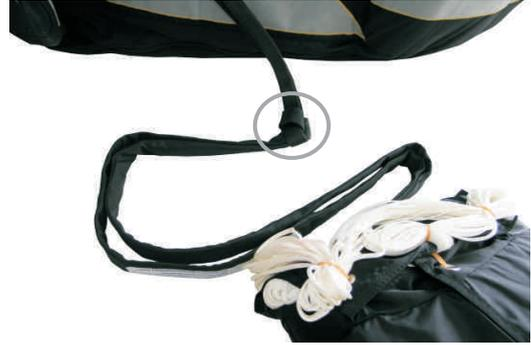
Verbindungsleine des Rettungsschirms mit der Verbindungsleine des Gurtzeuges einschlaufen.
