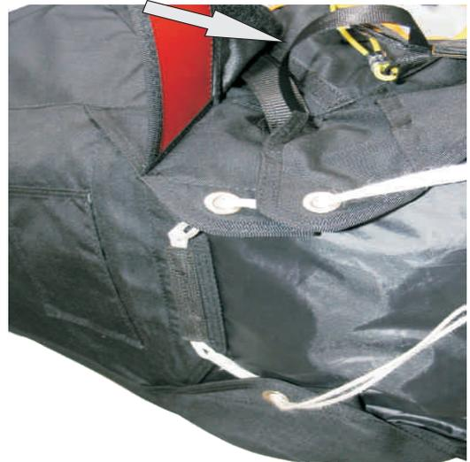
Container mit Hilfe zweier Packschnüre verschließen. Zuerst werden die seitlichen Containerlappen geschlossen. Das Band vom Auslösegriff verläuft zwischen den geteilten seitlichen Lappen. Es muss darauf geachtet werden, dass das Band vom Auslösegriff behinderungsfrei verlegt wird und ausreichend lang aus dem Container schaut und während der Auslösung der Zug nicht zuerst auf den Innencontainer sondern auf das gelbe Verschlusskabel kommt.
