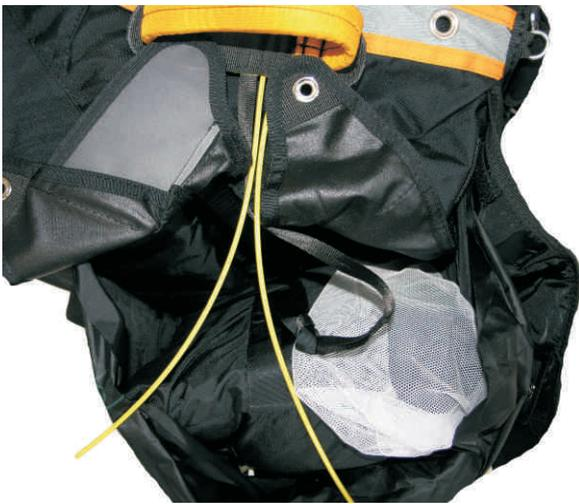
Die Verbindungsleine im Container verstauen. Diese muss zwischen Innencontainer und Gurtzeug liegen. Die Griffverbindung zum Innencontainer muss wie in der Abbildung ersichtlich ebenfalls zwischen Innencontainer und Gurtzeug liegen, d.h. nach innen schauen. Damit ist eine Auslösung mit wenig Auslösekraft gewährleistet um den Rettungsschirm leicht freizusetzen.
