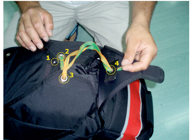
2. Reihenfolge für das Verschließen des Back Containers.
