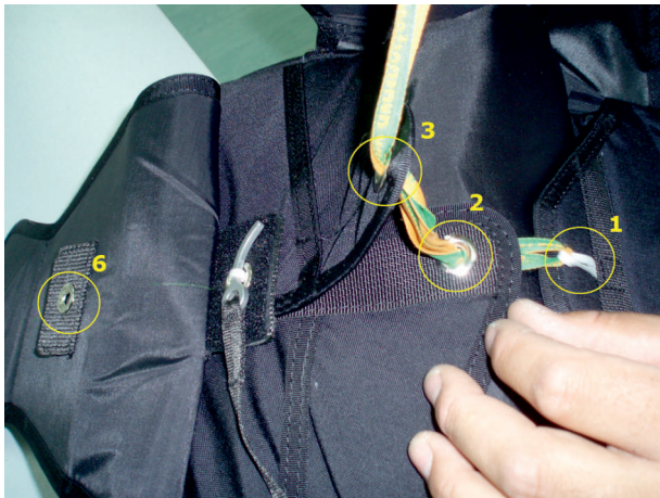
7. Reihenfolge für das Verschließen des Gurtzeugcontainers für den Splint #2 des Auslösegriffes
