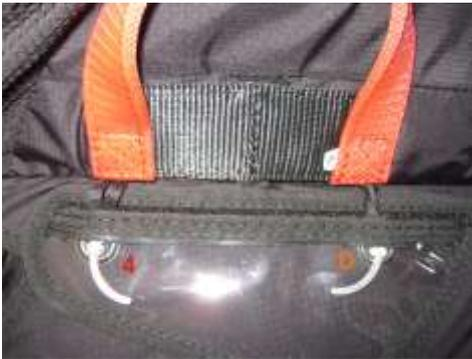
Abb. 11: Vordere Verschlusslasche mit Splinten gesichert, Auslösegriff verstaut
