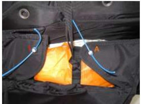
Abb. 8: Verschlussgummis mit Hilfsmittel
