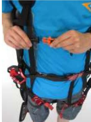
Abb. 30: Verbindungsgurt schließen
