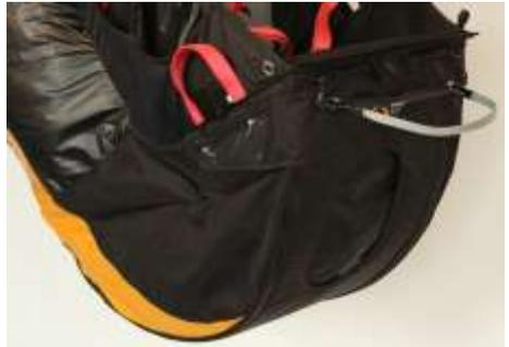
Abb. 3: Vorgefüllter Airbag mit Lufteinlassventil
