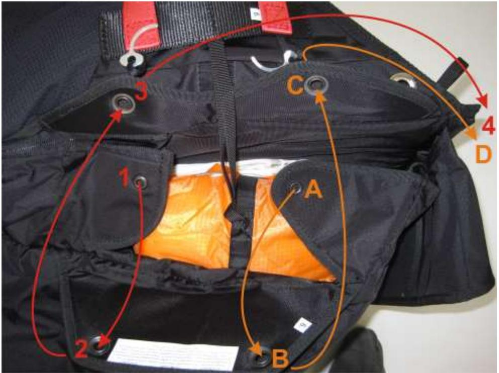
Abb. 7: Retter im Rettungsfach, Verschlussreihenfolge markiert
