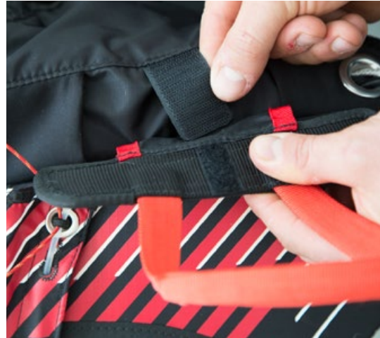
8. Plastikstäbe des Griffs durch die Gummis führen und enden in die Taschen schieben danach Griff am Klett befestigen
