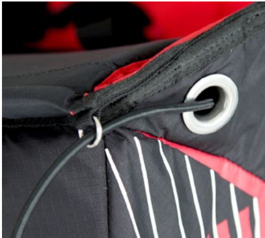
1. Rückhol Gummi einschlaufen. Dieser ist unter dem Sitzbrett fixiert und läuft durch eine Lasche auf der gegenüberliegenden Seite.
