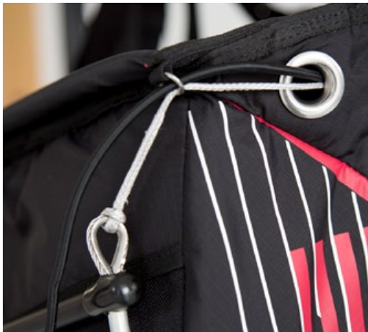
3. Einschlaufen der Beschleunigerleine durch den O-Ring und die Öse
