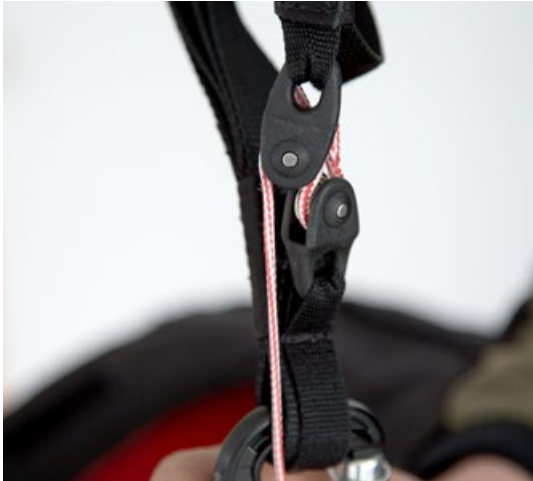
5. Einstellen der richtigen Länge volle Beschleunigung bei gestreckten Beinen
