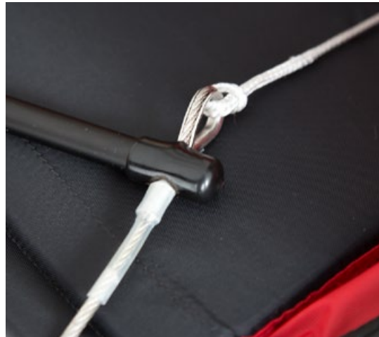
2. fixieren der Beschleuniger Leine am Beschleuniger
