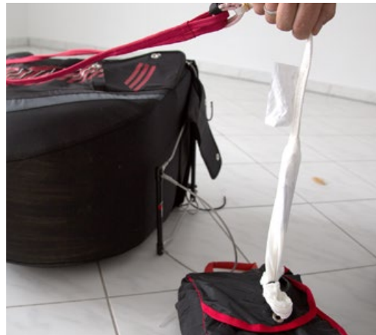
10. Zugtest, der Container muss durch sein Eigengewicht geöffnet werden
