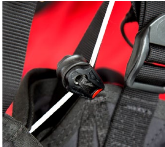
4. Einschlaufen durch die kugelgelagerte Umlenkrolle (Verdrehung der Rolle verhindern)
