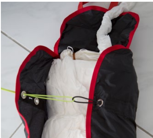
3. Blattcontainer mit Hilfe einer Packschnur gemäß den Nummerierungen verschließen
