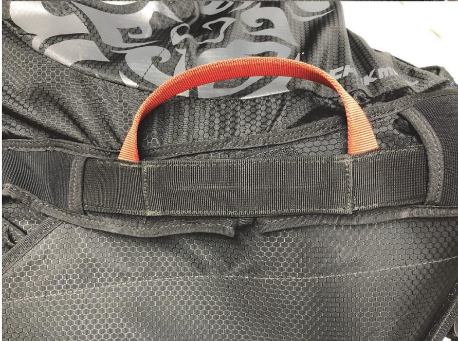
**BEACHTEN:** Bei einer Retteröffnung wird die Verbindungsleine aus dem Kanal gezogen und die Abdeckung geöffnet. Der Kanal der V-Leine muß beim Retterpacken wieder geschlossen werden. (Klett) Die Montage der Rettung darf ausschließlich von einer autorisierten Person (Händler/Flugschule) durchgeführt werden. Es ist ausschließlich Original-Zubehör zu verwenden. Nur der originale Auslösegriff garantiert die perfekte Auslösung der Rettung!
