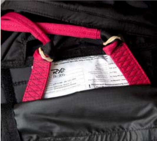
1. V-Leinen an den Laschen im Gurtzeug montieren und mit Gummis sichern
