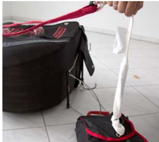
10. Zugtest, der Container muss durch sein
