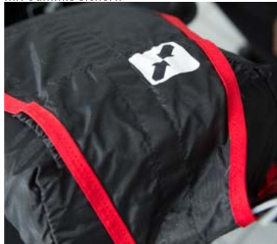
4. Container mit Markierung nach oben in das Retterfach einsetzen
