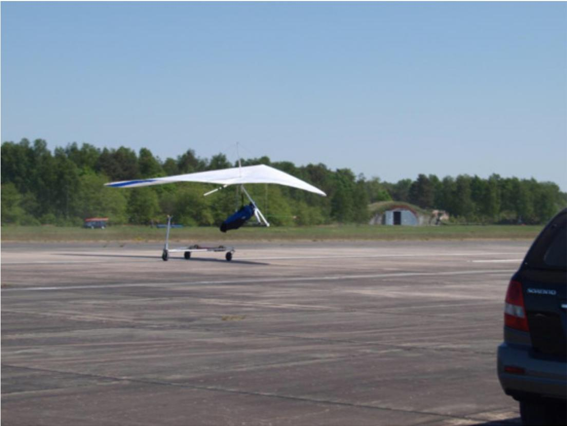
**Foto 6** : Falsche Pilotenhaltung, der Pilot lässt sich vom Seilzug nach vorne ziehen und erreicht so eine sehr hohe Abhebegeschwindigkeit! Dies führt häufig zum Kavaliertstart und damit zum Übersteigen des Schleppflugzeugs.
