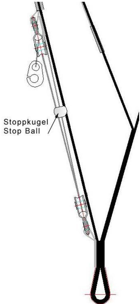
fixiert) eingestellt werden. Wird die Stoppkugel nach oben verschoben, verlängert sich der Beschleunigerweg. Ein Verschieben der Stoppkugel nach unten bewirkt hingegen eine frühzeitige Sperre der unteren Rolle, verkürzt dadurch den Beschleunigerweg und erhöht den Druck.
