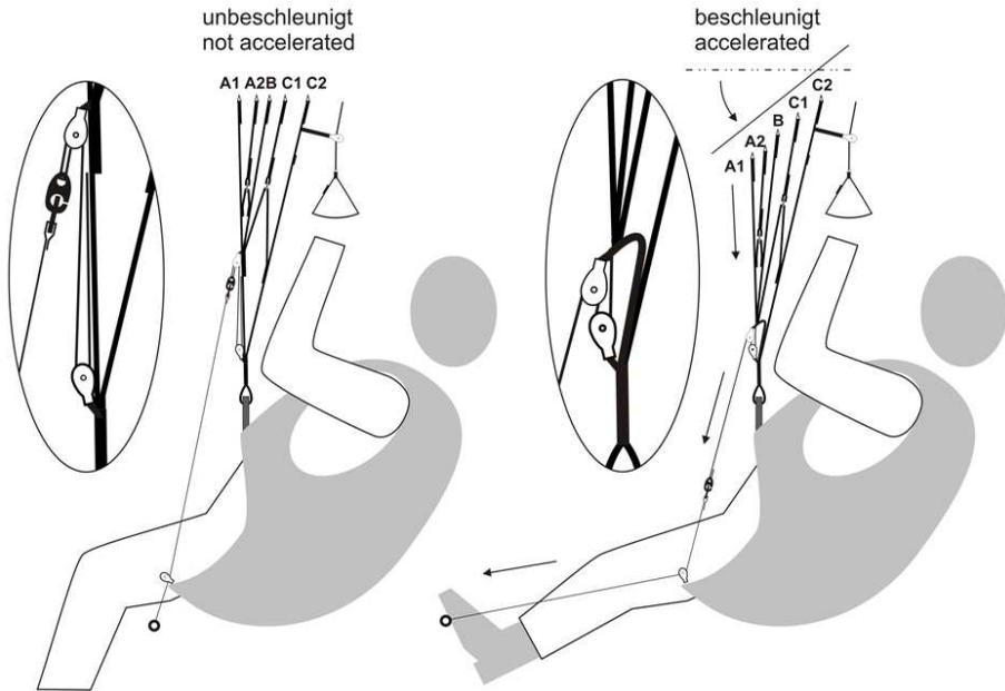
**Abbildung 5:** Funktionsweise Fußbeschleuniger Astral 7
