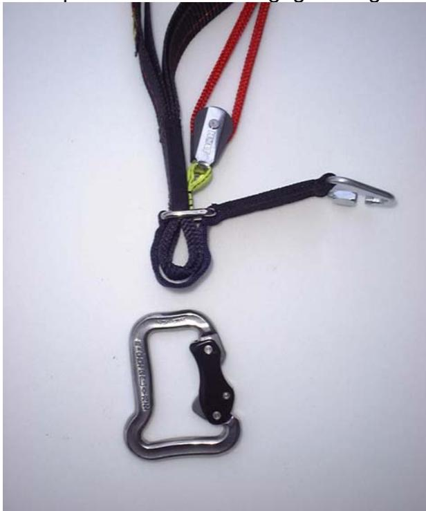
2. Der Karabinerhaken, der am Gurtzeug hängt, wird in den **Tragegurt** und den **Klinkenadapter** eingehängt
